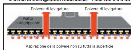
Sistema di smerigliatura tradizionale - Mola con 6 o 8 fori
