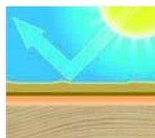
I raggi UV del sole e le intemperie consumano la lignina, la parte portante del legno: la superficie del legno ingiallisce, poi diventa grigia, non resiste più all'acqua e le vernici non tengono più in modo sufficiente.
