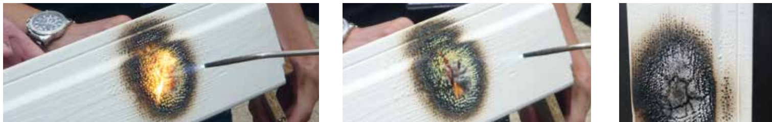
Test prova fuoco con pannello rivestito TEKNOSAFE 2407
